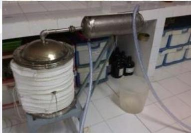
**Gambar 4.7 Gambar Reaktor Pirolisis**
