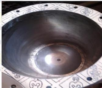
**Gambar 4.8 Dalam Reaktor Pirolisis**
