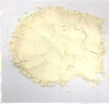
Gambar 4.2 Metakaolin yang telah dihaluskan
