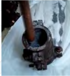
Gambar 4.8 Proses Perojokan Campuran
