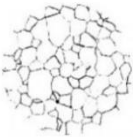
Gambar 4.6 Struktur Mikro Base Metal 80 A
