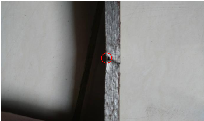
Gambar 4.20 Cacat Incomplete Fusion pada 100 Ampere
