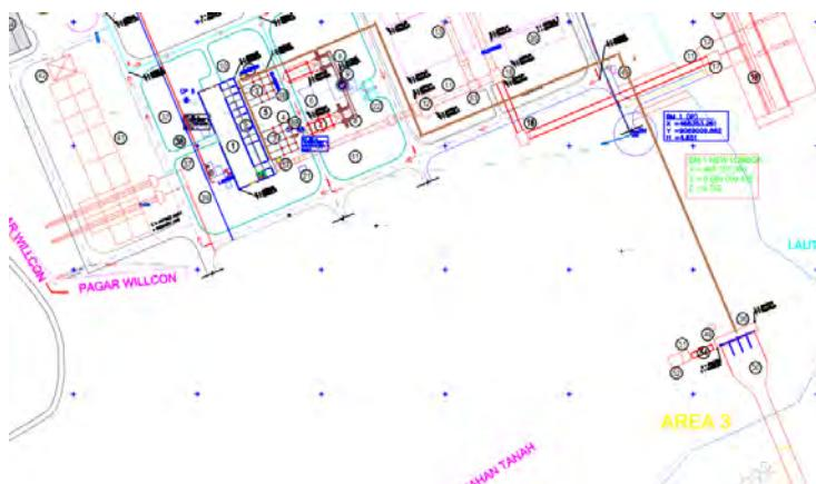
Gambar 4. 6 Alternatif 3 Desain Jaringan Perpipaan Untuk Tahap 2
