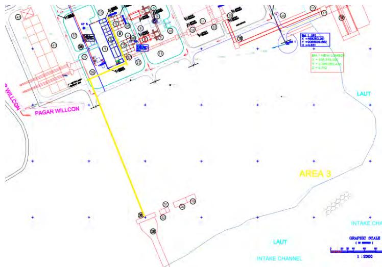
Gambar 4. 2Alternatif 1 Desain Jaringan Perpipaan Untuk Tahap 2
