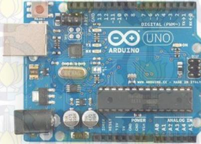
**Gambar 2.16** Bentuk Fisik Sistem Minimum Arduino Uno R3
