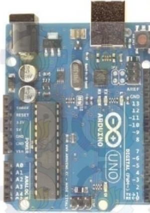
**Gambar 3.13** Bentuk Fisik Sistem Minimum Arduino Uno R3
