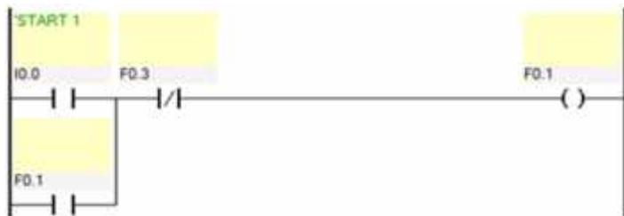
Gambar 2.22 Latch Realisasi Ladder Diagram
