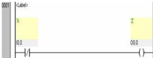
**Gambar 2.17 Logika NOT. Realisasi Ladder Diagram**
