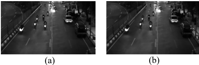
Gambar 5.3. Hasil proses noise filtering , (a) Citra sebelum noise filtering , (b) Citra setelah noise filtering
