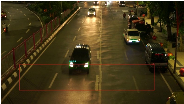
Gambar 5.18. Hasil deteksi dan pairing salah satu frame pada video 3
