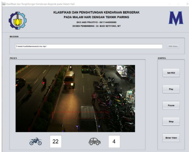
Gambar 5.16. Penghitungan video 2 dengan lebar ROI 40 piksel
