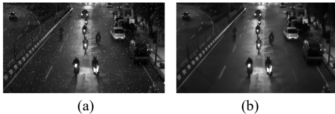
Gambar 4.6. Noise filtering , (a) Citra dengan noise , (b) Citra dengan noise yang telah dihilangkan
