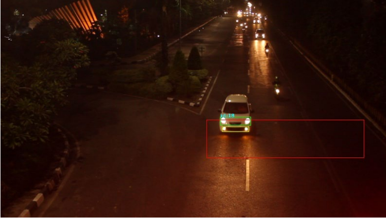
Gambar 5.7. Hasil deteksi dan pairing salah satu frame pada video 1
