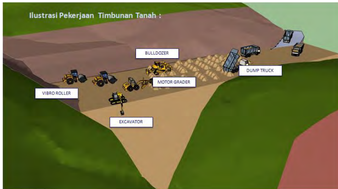
Gambar 4.11 Penghamparan dan Pematatan Material Timbunan
