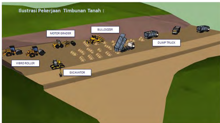
Gambar 4.12 Pembentukan Kemiringan Slope
