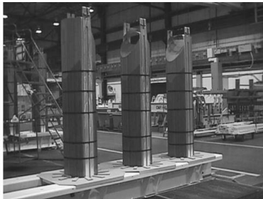
Gambar 2.5 Inti besi dan laminasi yang diikat fiber glass
