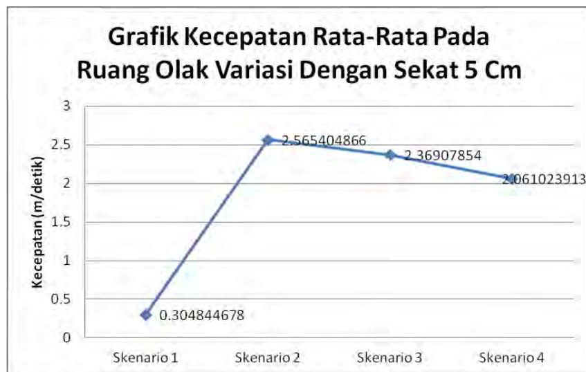
Gambar 4.19 Grafik Kecepatan Aliran Rata-Rata Pada Variasi Sekat 5 cm.
