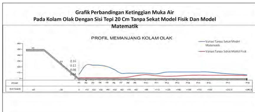
Gambar 4.35 Grafik Perbandingan Ketinggian Muka Air Pada Model Dengan Sisi Tepi 20 cm (Tanpa Sekat).
