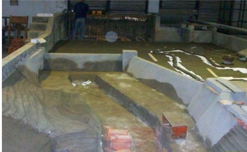
Gambar 1.1 Model Fisik Kolam Olak Bendung Watumloso.
