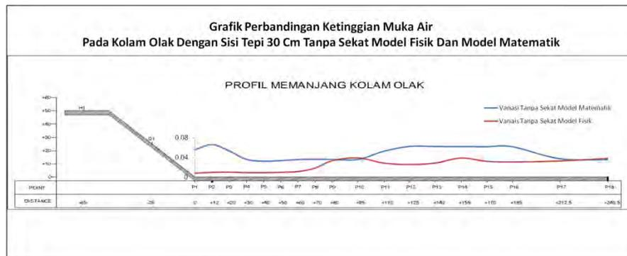
Gambar 4.36 Grafik Perbandingan Ketinggian Muka Air Pada Model Dengan Sisi Tepi 30 cm (Tanpa Sekat).
