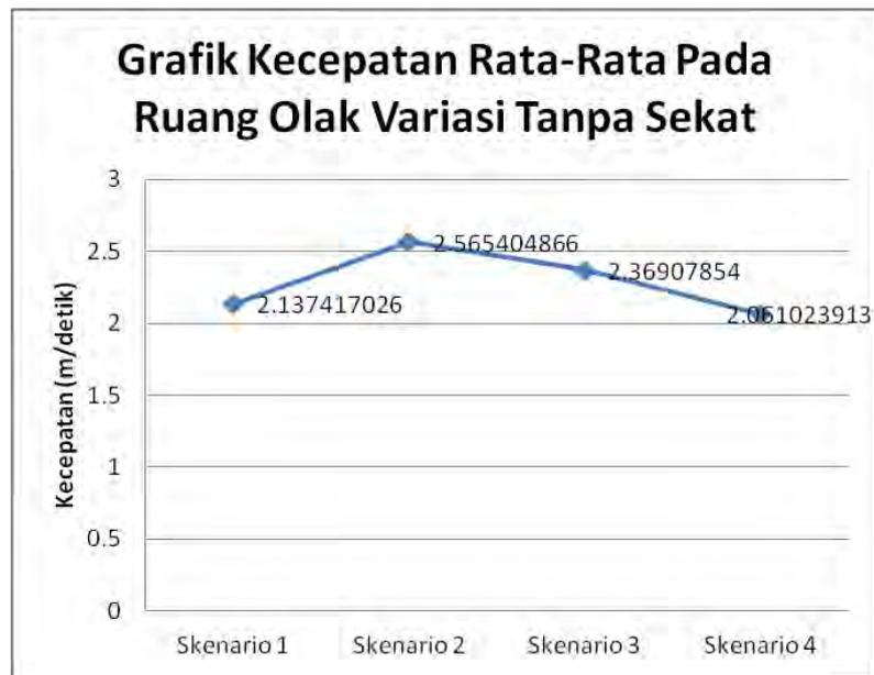
Gambar 4.14 Grafik Kecepatan Aliran Rata-Rata Pada Variasi Tanpa Sekat.
