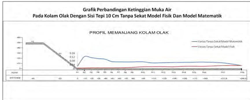
Gambar 4.34 Grafik Perbandingan Ketinggian Muka Air Pada Model Dengan Sisi Tepi 10 cm (Tanpa Sekat).
