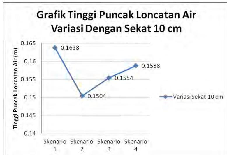
Gambar 4.26 Grafik Tinggi Puncak Loncatan Air Pada Variasi Sekat 10 cm.
