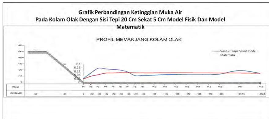
Gambar 4.38 Grafik Perbandingan Ketinggian Muka Air Pada Model Dengan Sisi Tepi 20 cm (Sekat 5 cm).
