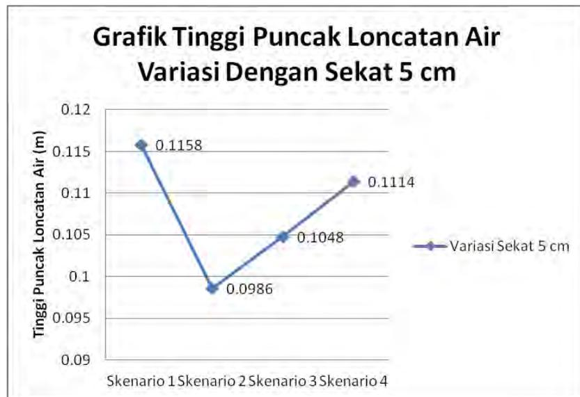
Gambar 4.21 Grafik Tinggi Puncak Loncatan Air Pada Variasi Sekat 5 cm.
