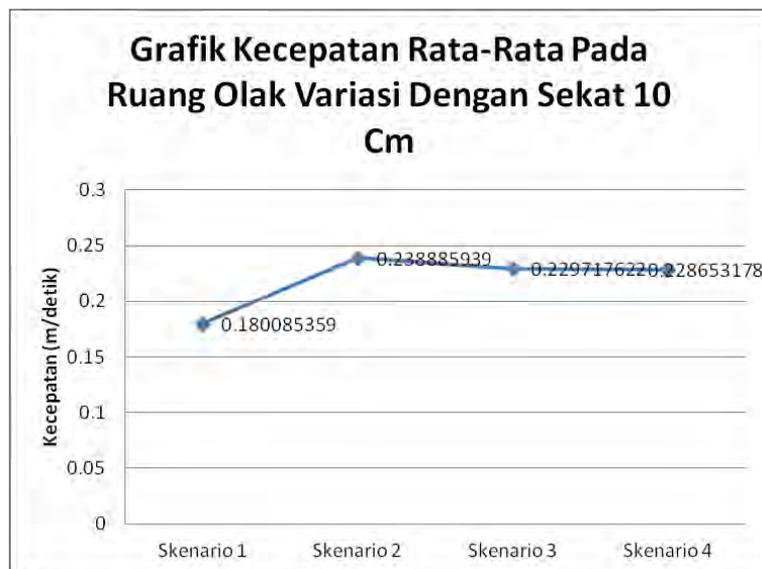
Gambar 4.24 Grafik Kecepatan Aliran Rata-Rata Pada Variasi Sekat 10 cm.
