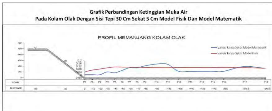
Gambar 4.39 Grafik Perbandingan Ketinggian Muka Air Pada Model Dengan Sisi Tepi 30 cm (Sekat 5 cm).
