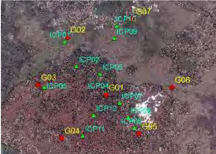
Gambar 4.2 Penentuan Titik GCP dan ICP pada Citra Satelit Pleiades 1A
