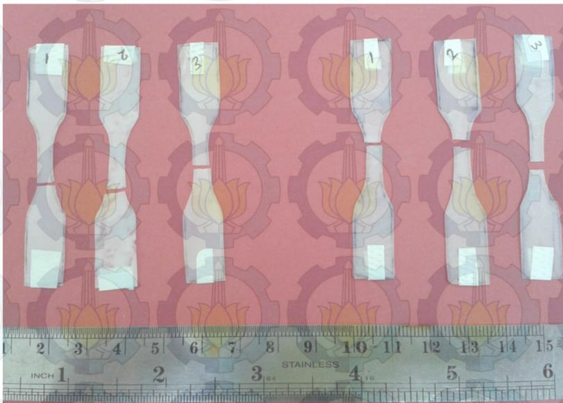
**Gambar A.1** Spesimen Uji Tarik
