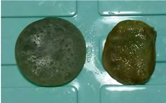
Gambar 4.7 Membran Sebelum Filtrasi (a), Sesudah Filtrasi (b)
