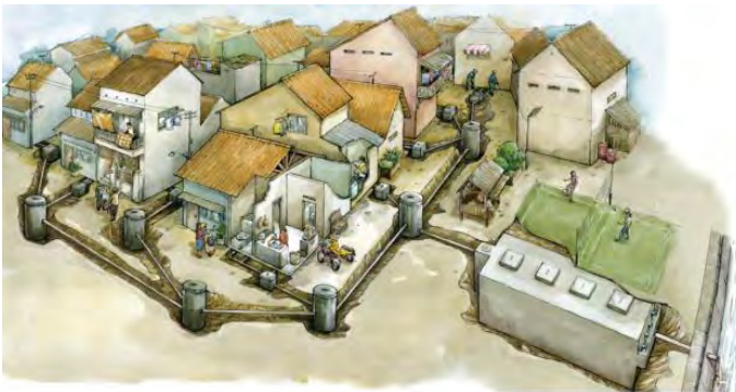
Gambar 2.2 Sistem Pengelolaan Air Limbah Domestik Terpusat Sumber: Iskandar dkk., 2016
