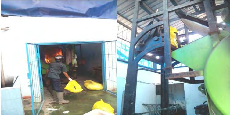
Gambar 5.25 Pengumpanan Limbah Medis Padat Melalui *Chamber* dan *Lifter*
