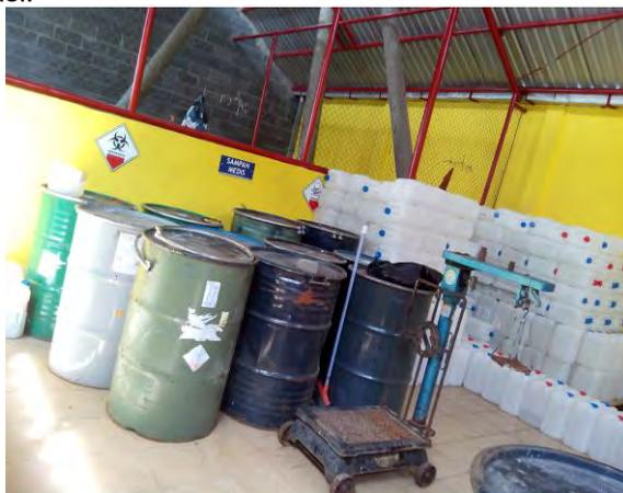
Gambar 5.31 Drum Abu Pasca Insinerasi yang Disimpan di TPS Limbah B3
