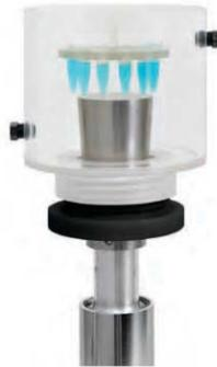
Gambar II.2 Alat untuk *Indirect Sonication*
