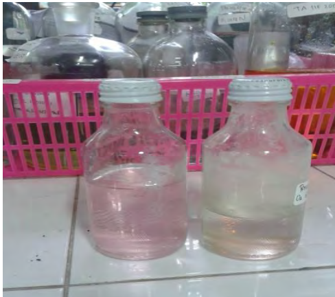
Gambar A.9 Bahan Kimia ( MnSO_4 dan Pereaksi Oksigen) Untuk Pengawetan Sampel Air
