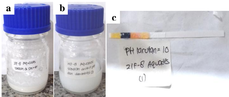
Gambar 4.8 a) Campuran dari (\text{Zn}(\text{NO}_3)_2 \cdot 4\text{H}_2\text{O}) dan 2-methylimidazole setelah diaduk dengan magnetic stirrer (putih keruh). b) ZIF-8 setelah diukur pH dan didekantasi (putih bening). c) pH ZIF-8 Aquades = 10 sebelum dicuci dengan metanol.
