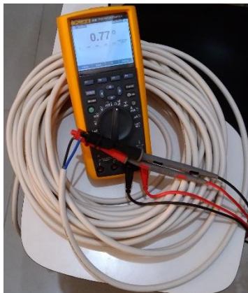
Gambar 3. 8 Panjang Kabel 24 m, Impedansi 0.77 ohm
