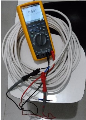
Gambar 3. 7 Panjang Kabel 18 m, Impedansi 0.59 ohm
