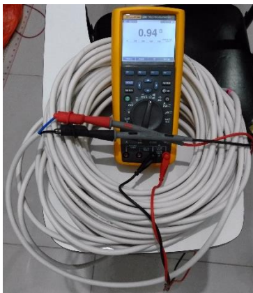
Gambar 3. 9 Panjang Kabel 30 m, Impedansi 0.94 ohm
