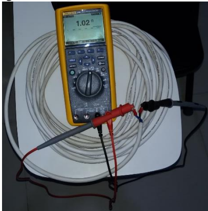
Gambar 3. 6 Panjang Kabel 12 m, Impedansi 1.02 ohm
