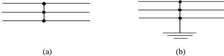
Gambar 2. 1 (a) hubung singkat tiga fasa (L-L-L), (b) hubung singkat tiga fasa ke tanah (L-L-G)
