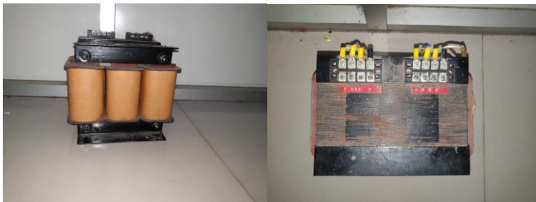
Gambar 3.1 Transformator uji 3 kVA 3 fasa
