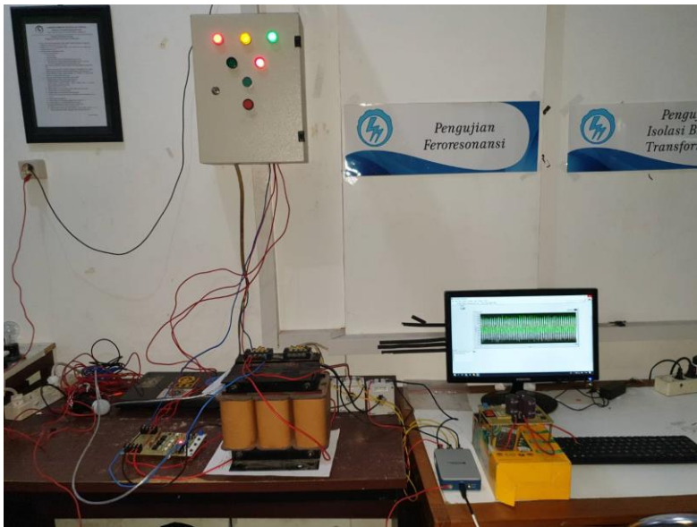
Gambar 4.4 Proses pengambilan data arus inrush pada transformator
