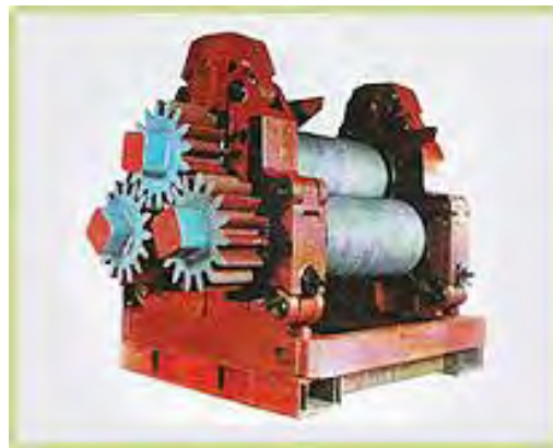
Gambar 4. 4 Mesin Penggilingan Tebu (sumber : http://www.sugartech.in )
