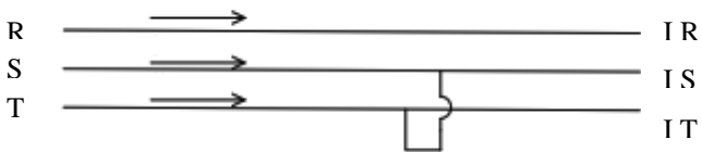
Gambar 2.3 Gangguan hubungan singkat Line-Line
