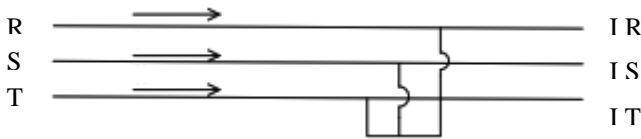
Gambar 2.4 Gangguan hubungan singkat 3 fasa
