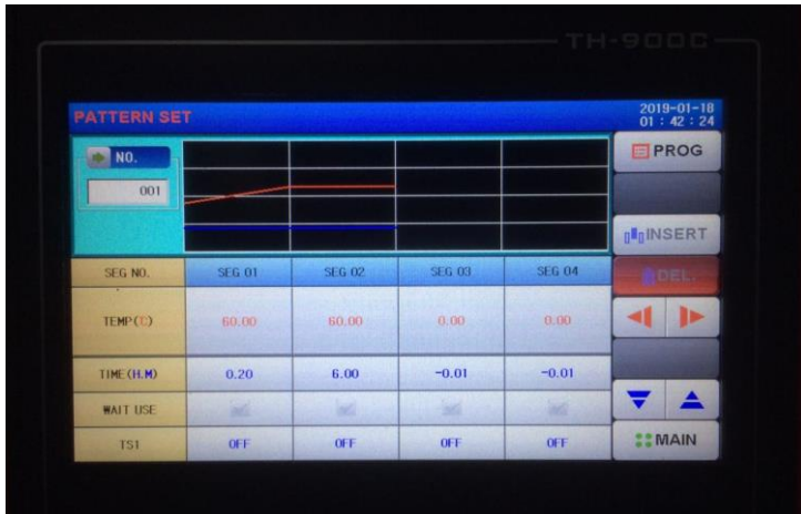
Gambar 4.14 Pengaturan temperatur 60°C pada thermal chamber
