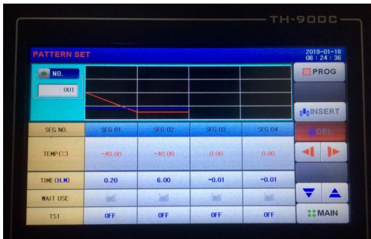
Gambar 4.15 Pengaturan temperatur -40°C pada thermal chamber
