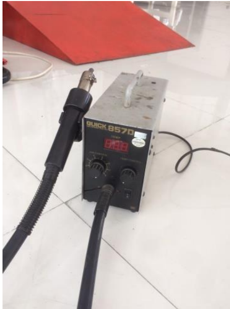
Gambar 4.7 Blower yang digunakan untuk meningkatkan temperatur pada sensor suhu BMS
