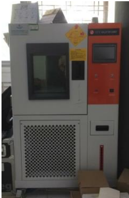
Gambar 4.12 Thermal chamber pengujian
