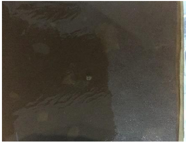
Gambar 4.13 Kertas Kraft yang telah dipanaskan pada suhu 30°C didalam minyak sintesis dan telah mengalami tegangan tembus
