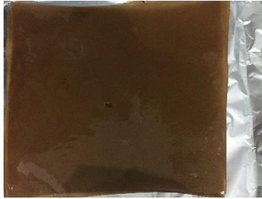
Gambar 4.5 Kertas Kraft yang telah dipanaskan pada suhu 110^{\circ}\text{C} didalam minyak nabati dan telah mengalami tegangan tembus
