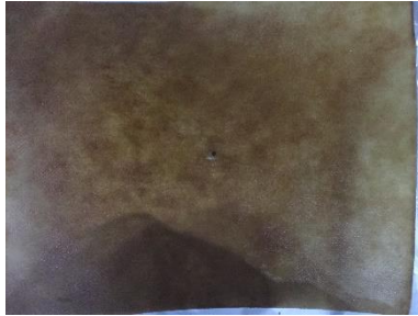
Gambar 4.8 Kertas Kraft yang telah dipanaskan pada suhu 50°C didalam minyak mineral dan telah mengalami tegangan tembus
