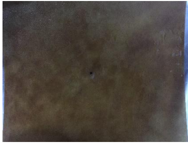
Gambar 4.9 Kertas Kraft yang telah dipanaskan pada suhu 70°C didalam minyak mineral dan telah mengalami tegangan tembus
