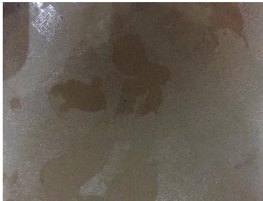
Gambar 4.1 Kertas Kraft yang telah dipanaskan pada suhu 30°C didalam minyak nabati dan telah mengalami tegangan tembus
