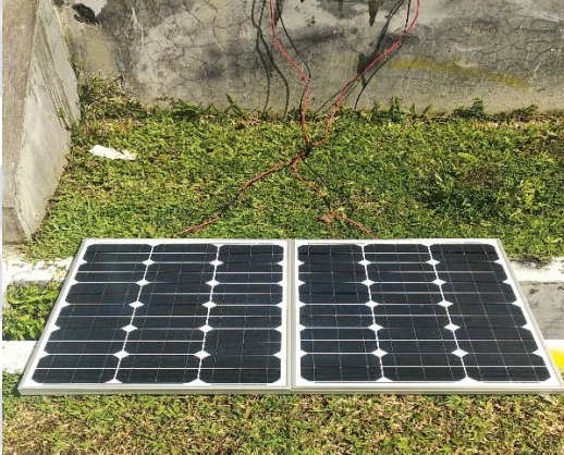
Gambar 3.33 pengujian MPPT pada dua panel PV 50Wp
