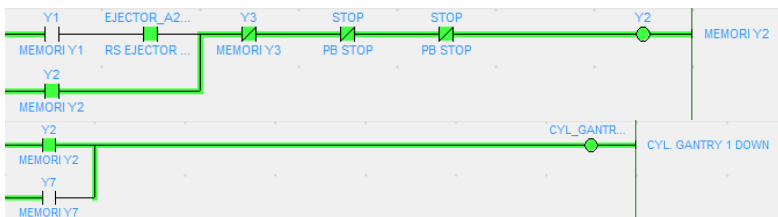
Gambar 4.12. Pengujian Relay Y2 pada CX-Programmer
