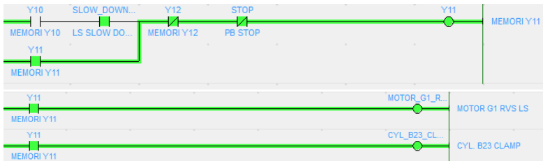
Gambar 4.40. Pengujian Relay Y11 pada CX-Programmer
