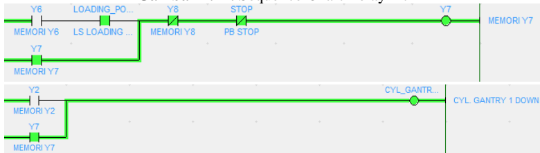
Gambar 4.28. Pengujian Relay Y7 pada CX-Programmer
