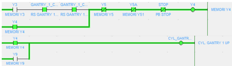
Gambar 4.18. Pengujian Relay Y4 pada CX-Programmer
