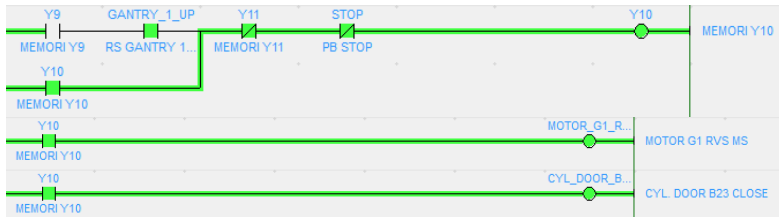
Gambar 4.37. Pengujian Relay Y10 pada CX-Programmer
