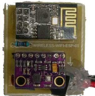
**Gambar 3.8** Hasil Cetak PCB
