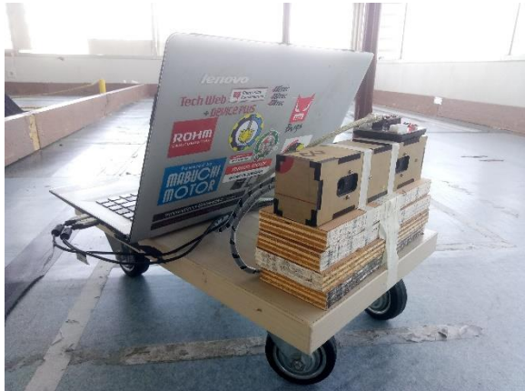
Gambar 3-5 Mock Mobile Robot dengan kamera stereo dan laptop yang digunakan
