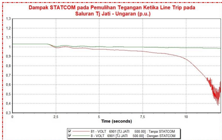
Gambar 4. 7 Grafik Dampak STATCOM pada Pemulihan Tegangan di Bus Tanjung Jati
