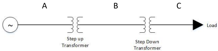
Gambar 2. 2 Pembagian Zona Tegangan pada Transmisi
