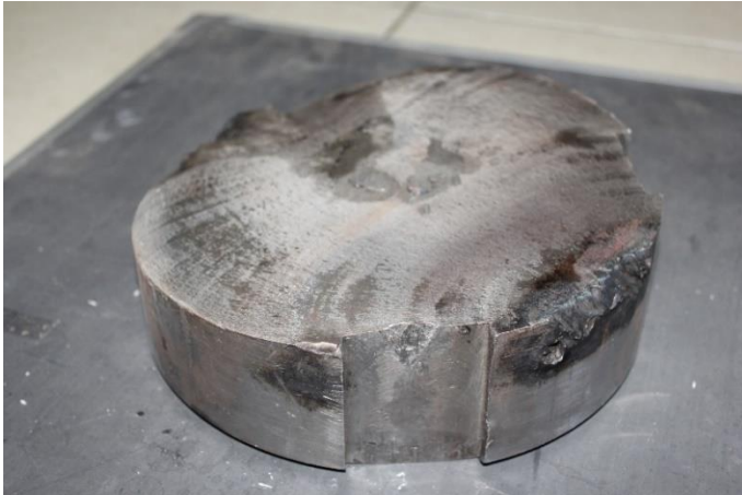
Gambar 3. 2 Penampang patahan shaft mesin uap
