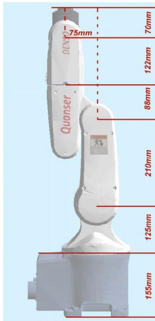
Gambar 3.1 Panjang Lengan Robot Denso VP-6242G [6]
