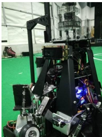
Gambar 4. 10 Penempatan sensor kamera dan LiDAR pada robot
