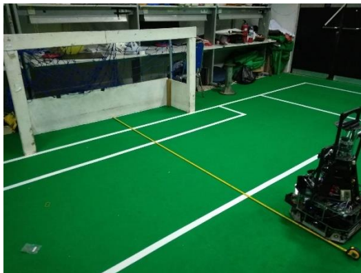
Gambar 4. 4 Pengukuran jarak pada robot menggunakan LiDAR
