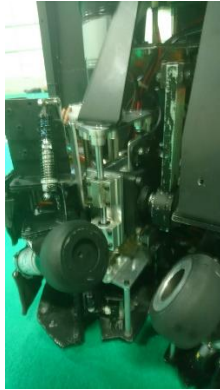
Gambar 4. 6 Posisi penempatan mekanisme penendang
