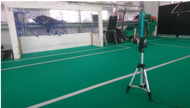
Gambar 4. 1 Penempatan kamera untuk pengujian deteksi gawang
