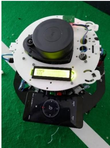
**Gambar 4.7** Pengujian sensor CMPS11.
