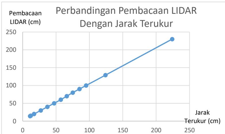
**Gambar 4.2** Grafik perbandingan pembacaan LIDAR dengan jarak terukur.
