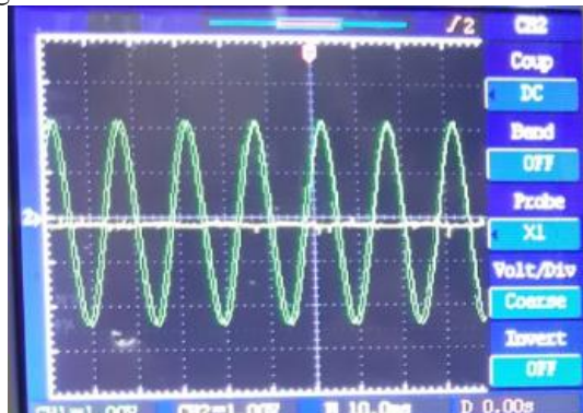
Gambar 4. 2 Pengujian Switch analog dengan Volume 0%
