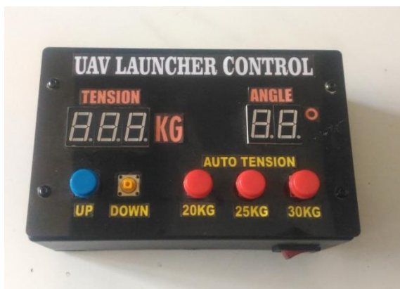
Gambar 3.6. Remot pengendali peluncur UAV
