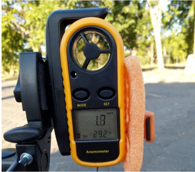
Gambar 4.8 Pengukuran Kecepatan Angin
