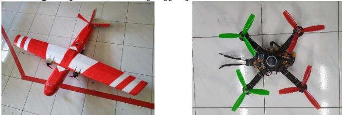
Gambar 2.6 Pesawat fixed-wing (kiri) dan quadcopter (kanan)
