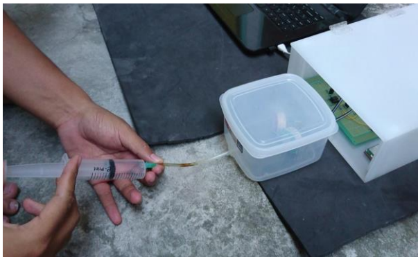
Gambar 4.9 Penyuntikan sampel gas kedalam ruang gas uj
