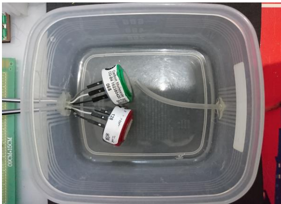
Gambar 4.7 Realisasi sensor gas di ruang gas uji
