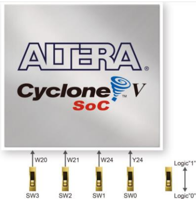
Gambar 2.10 Koneksi antara Slide Switch dan Cyclone V SoC FPGA
