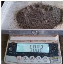
Gambar 3. 12 Menimbang pasir SSD sebanyak 500 gram
