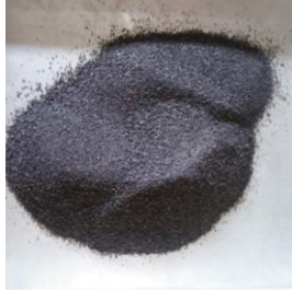
Gambar 2. 3 Agregat Halus (Pasir Lumajang) (Sumber : Dokumentasi Pribadi).
