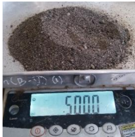
Gambar 3. 18 Menimbang pasir SSD sebanyak 500 gram
