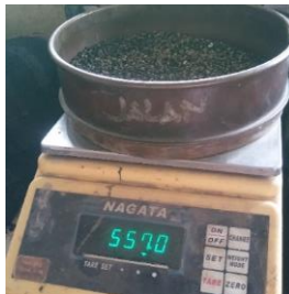
Gambar 3. 8 Menimbang setiap pasir yang tertinggal pada setiap ukuran ayakan
