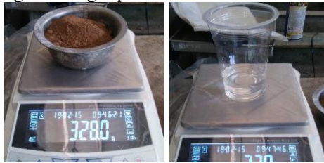
Gambar 3. 28 Menimbang semen geopolimer dan air
