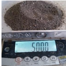
Gambar 3. 15 Menimbang pasir kondisi asli 500 gram
