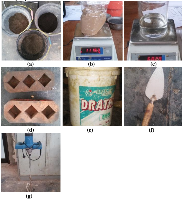
Gambar 3. 31 Bahan: (a) Agregat halus (pasir), (b) Semen geopolimer dan (c) Air. Alat: (d) Mold 5x5 cm, (e) Timba plastic, (f) Cetok, dan (g) Hand mixer
