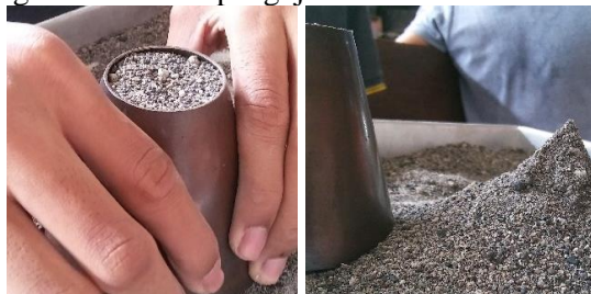
Gambar 3. 11 Pasir kondisi SSD
