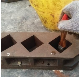
Gambar 3. 32 Mengoleskan oli pada permukaan cetakan
