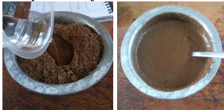
Gambar 3. 29 Pembuatan pasta semen geopolimer
