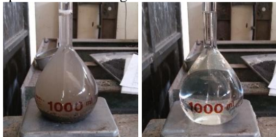
Gambar 3. 14 Menimbang labu takar+pasir+air dan menimbang labu takar berisi air
