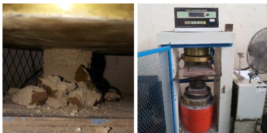
Gambar 3. 43 Pengujian kuat tekan mortar geopolimer
