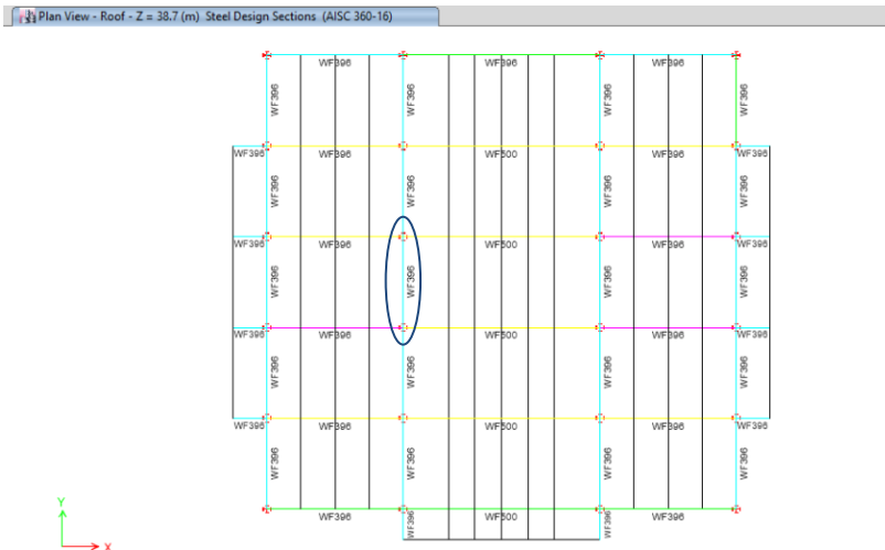
Gambar 5. 4 Lokasi WF396, L=6m
