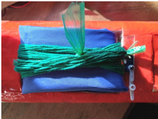
Gambar 3.11 Parasut yang Dimasukkan di Tempat Parasut
