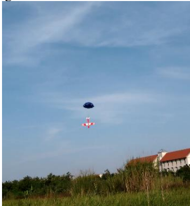
Gambar 4.4 Percobaan Pertama, Parasut Terbuka
