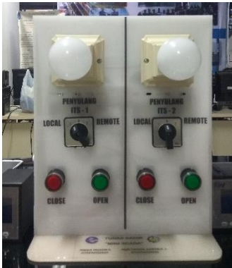
Gambar 3.5 Tampak Depan Mini SCADA
