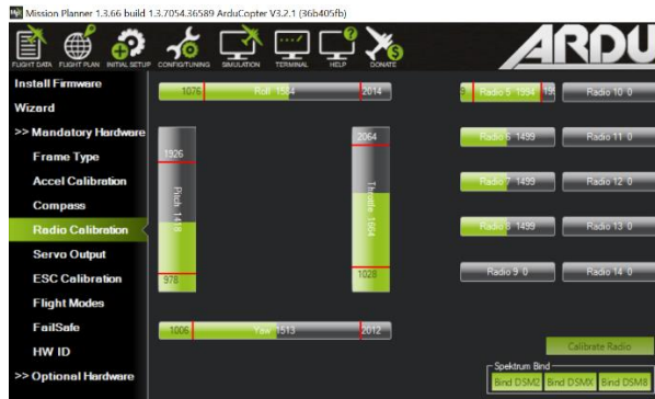
Gambar 3.23 Proses Kalibrasi Input PWM dari remote
