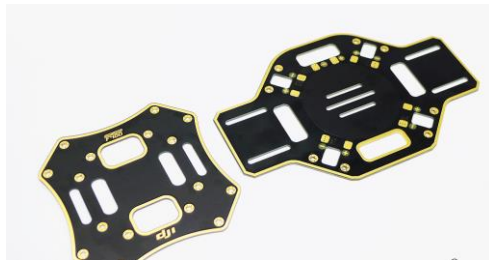
Gambar 3.9 Power Distribution Board pada frame F450[34]
