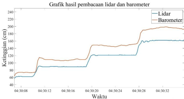
Gambar 4.2 Perbandingan hasil pembacaan lidar dan barometer
