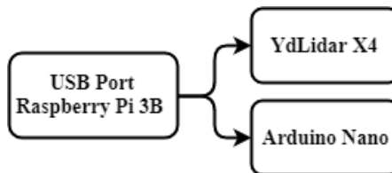
Gambar 3.5 Alur catu daya YdLidar dan Arduino
