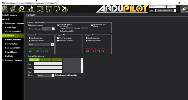
Gambar 3-15 Kalibrasi Kompas pada Mission Planner
