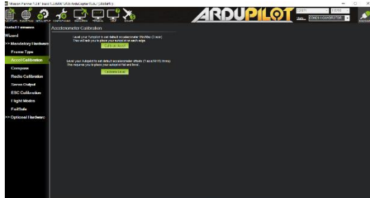
Gambar 3-16 Kalibrasi Acel dan Level pada Mission Planner
