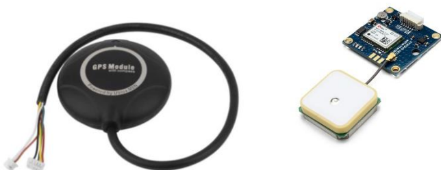
Gambar 2.9 Modul, antenna, dan chip Ublox M8N [6].
