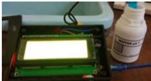
Gambar 4.1. Kalibrasi Dengan pH Buffer 7
