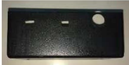
Gambar 3.12. Posisi lubang sensor
