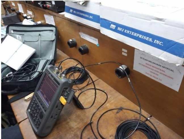
Gambar 3.23 Ilustrasi Pengukuran Kabel
